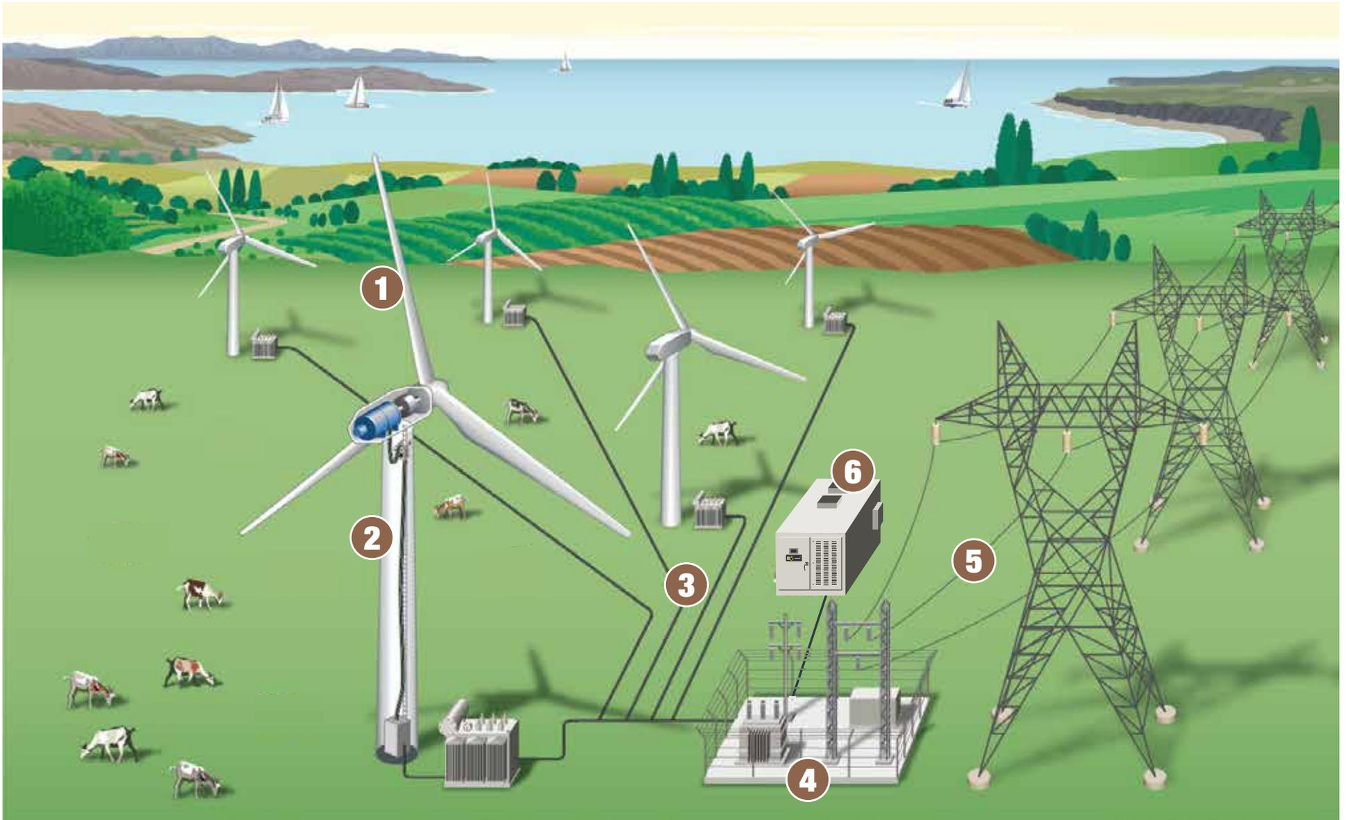
1 BLADE GROUNDING CABLE 2 WIND TOWER CABLE 3 COLLECTION SYSTEM CABLE 4 SUBSTATION CABLE 5 TRANSMISSION CABLE 6 ENERGY STORAGE
